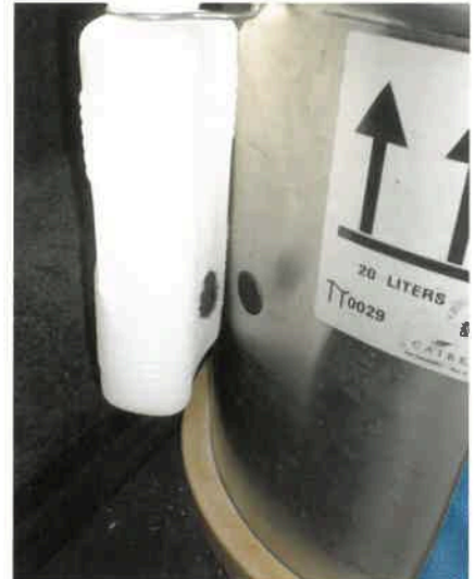
Befestigung des Überlaufs mit Klettband
